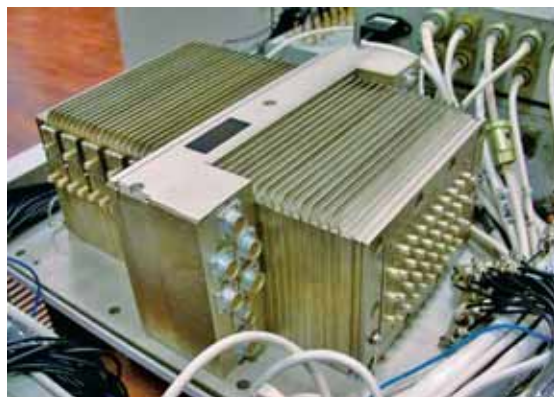
Прототип бортовой цифровой платформы на испытательном стенде
