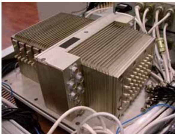
Бортовая цифровая платформа на испытательном стенде
