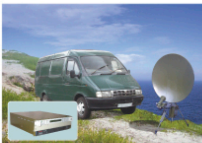
Мобильная перевозимая станция спутниковой связи «Центавр-НМ-2»
